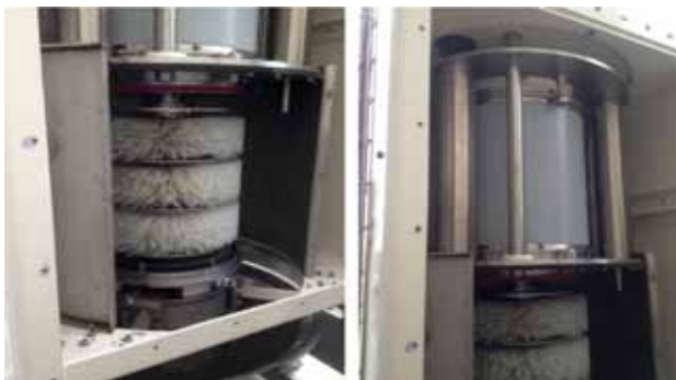
Binnenkant borstelcentrifuge (links), trommel (rechts)
