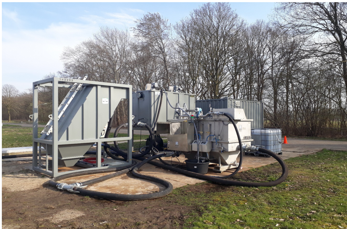
FIGUUR 5 OPSTELLING VAN DE PILOTINSTALLATIE RECHTS NAAST DE EFFLUENTGOOT MET LINKS DE LAMELLENSeparator, MIDDENACHTER DE CONTACTTANK, MIDDENVOOR HET DOEKFILTER, EN RECHTSACHTER DE CONTROLECONTAINER
